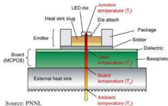
Con questo termine viene indicata la temperatura della giunzione che costituisce il nucleo del LED; la temperatura massima è determinata dal produttore del dispositivo in modo da porre un limite invalicabile per una vita operativa ragionevole del componente.
