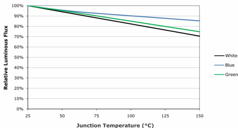
Il produttore indica per 350 mA e  $T_j=25^\circ\text{C}$  un flusso luminoso pari a 114 lm.
