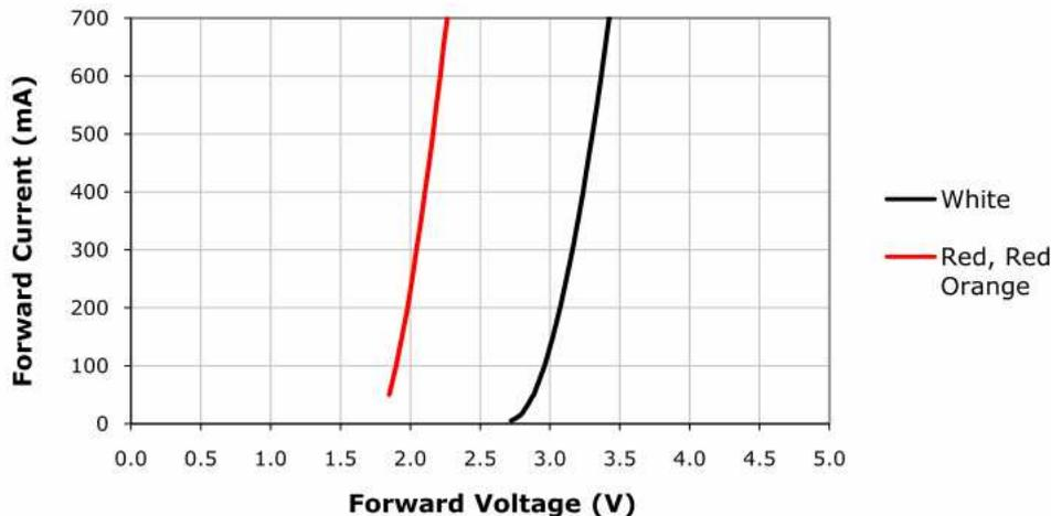
In questo caso si può vedere ad esempio come ad una corrente di 350 mA corrisponda un voltaggio di 3,2 V per un LED bianco e quindi una potenza assorbita di 1,12 W; per una corrente di 700 mA corrisponde un voltaggio di 3,4 V e quindi una potenza assorbita di 2,38 W. In realtà non è quindi vero quello che generalmente si vede stampato nelle caratteristiche delle sorgenti a LED e cioè che ogni singolo diodo assorba 1 W.
