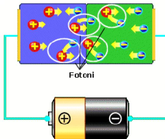
In pratica un LED trasforma l'energia elettrica in energia luminosa (e viceversa).
